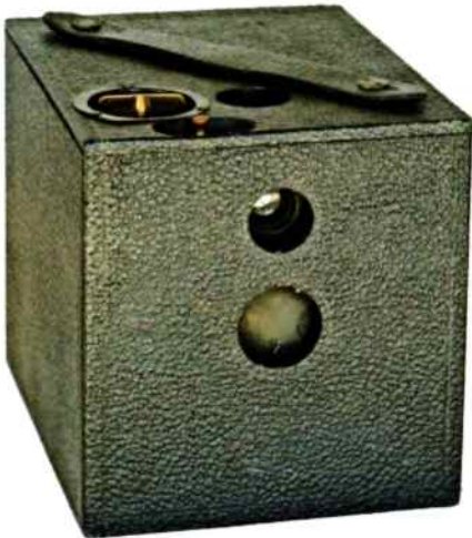
No. 2 Bullet, eerste model uit 1895-1896. Rolfilmcamera voor 9 x 9 cm opnamen op daglichtspoel. Sluiter voor moment- en tijdopname, geen diafragmakeuze, fixed focus lens.
